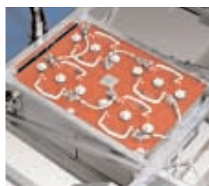
BATTERI 4 st uppladdningsbara rörplattbatterier. Kapacitet: 175 Ah/5 tim.
